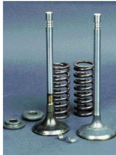
Fig 12: Valvole con molle, dischi e coni
